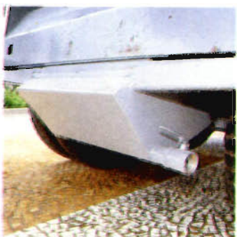
Reservatório para captação de líquidos (chorume)
